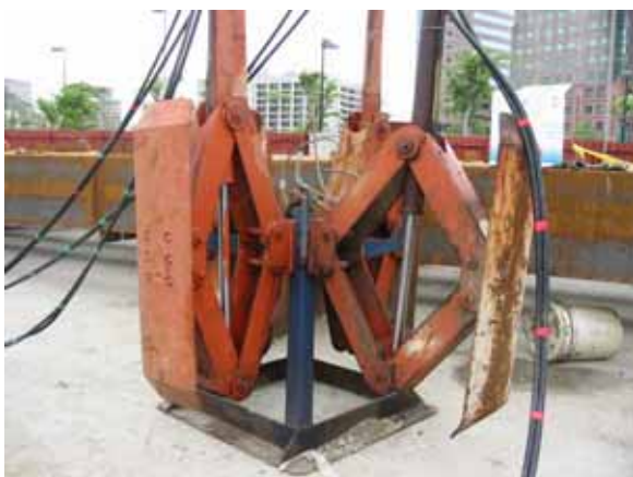
水中千斤頂，用以調整逆打鋼柱在基樁中之水平 xy 方向位置
