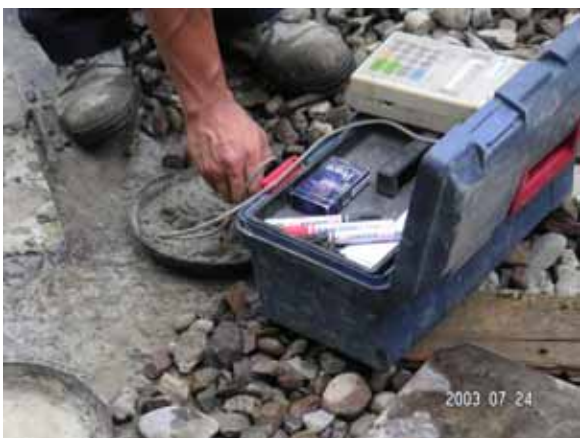
混凝土氯離子含量現場檢驗。
