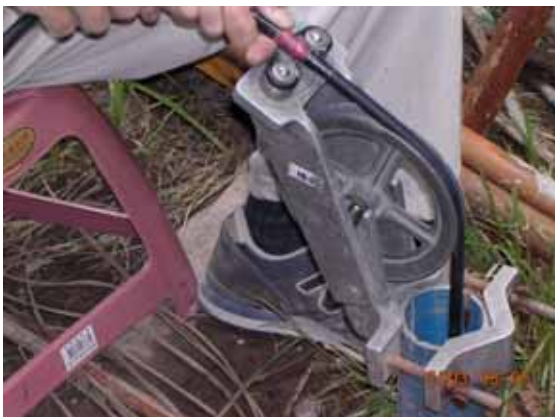
觀測初始值：依電纜線之標記（50cm）提升感應器
