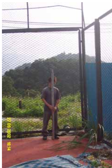
觀測初始值：豎立水準尺時，應使水準氣泡居中
