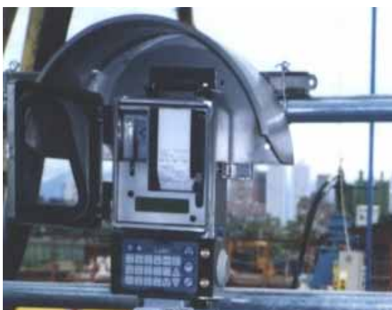
灌漿參數檢驗：灌漿流量測定(流量計)
