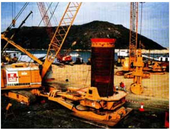
套管鑽掘施工機具搖管式全套管搖管機 LEFFER VRM 系列
