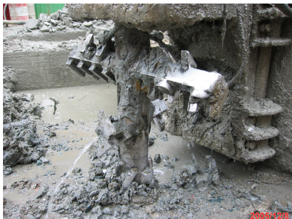
儀器介紹：攪拌翼（或稱攪拌葉片）
