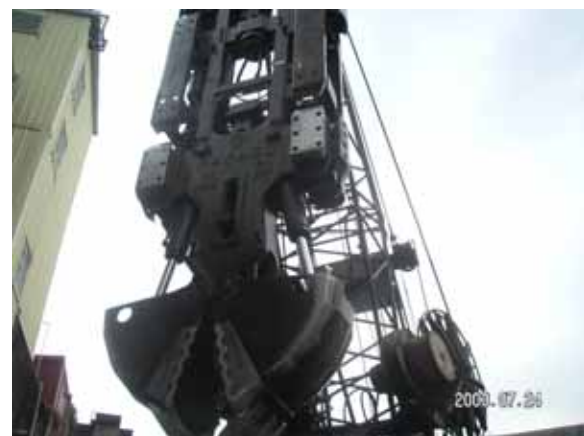
挖掘機打開抓斗將挖出之土壤倒入卡車中
