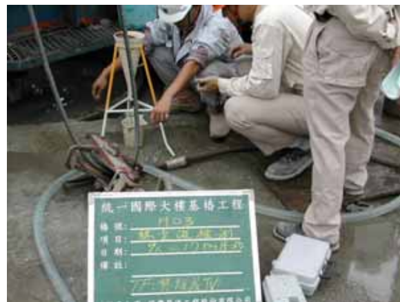
施工現場穩定液黏滯度檢測。
