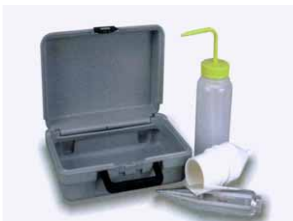
穩定液之含砂量試驗計。
