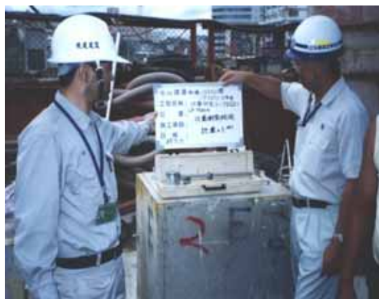
灌漿參數檢驗：水泥比重測定(比重計)
