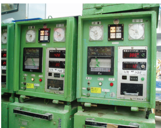
低壓灌漿：流量計設備，可紀錄灌漿流量及壓力
