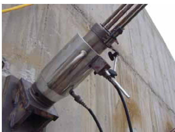
讀取鋼鍵施拉預力而產生的伸長量
