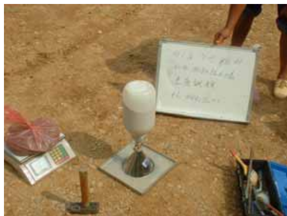
夯實土方土壤密度試驗(砂錐法)。
