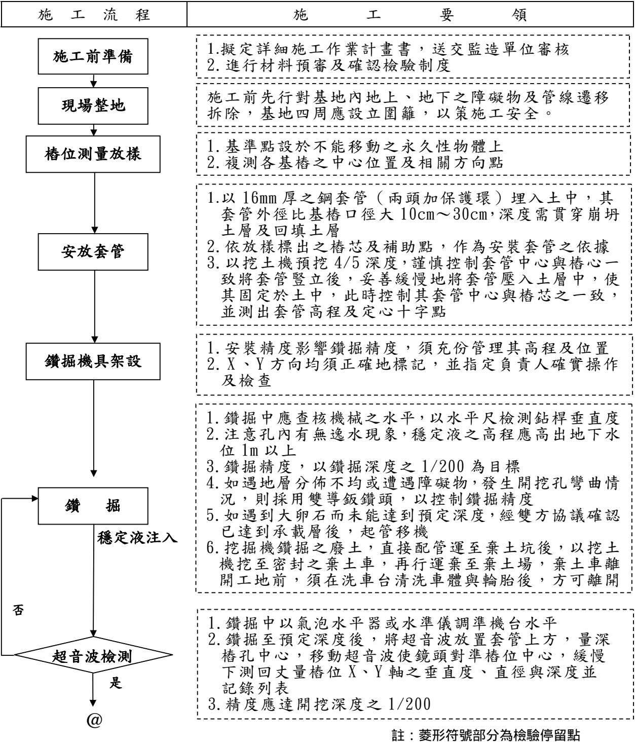
圖 1-7 反循環基樁工程施工要領作業流程圖
