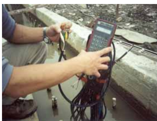
初始觀測：利用資料擷取器依觀測頻率量 測
