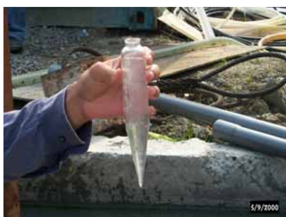
現地穩定液含砂量測試。
