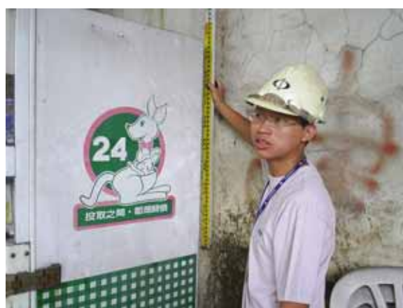
觀測後續值：豎立水準尺時，應使水準氣泡居中
