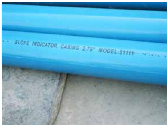
裝設前準備：確認壁體外傾度管尺寸
