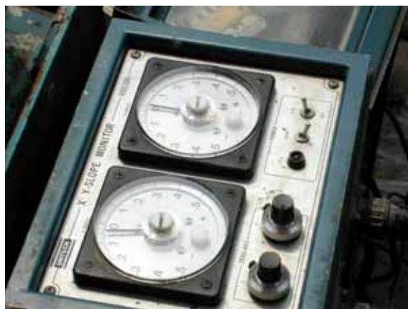
安裝於逆打鋼柱上之角度檢知器連接至地面上之角度指示儀，待逆打鋼柱吊放至預定深度並調整垂直度後，將儀器歸零，用以檢核之後混凝土澆置時之偏斜量。
