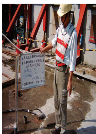
完工驗收：灌漿效果確認，施作透水試驗
