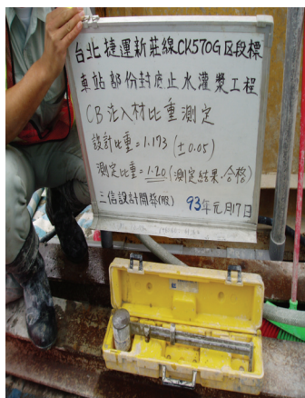
低壓灌漿：比重測定(比重計)
