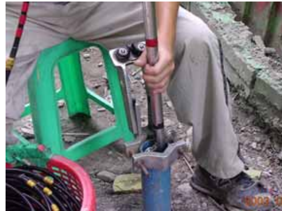
觀測初始值：置入雙軸感測器（先量測A+向再量測A-向，A+為感測器高導輪朝向開挖側，A-則反之）。
