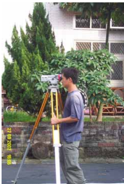
觀測初始值：以水準儀觀測各沉陷釘（過程中需定平）
