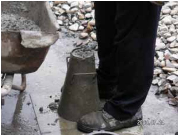
預拌混凝土現場坍度試驗。
