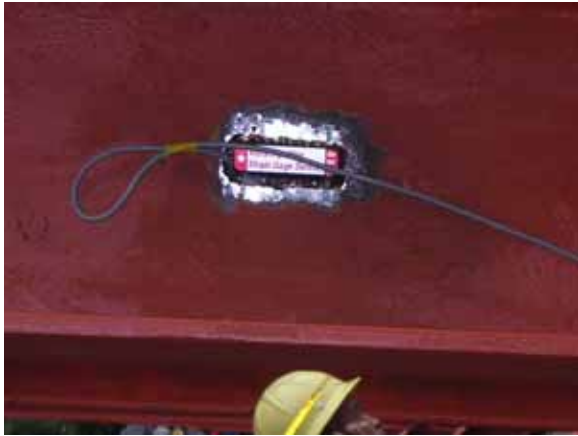
支撐型鋼表面處理：支撐應變計裝設前，先行於支撐型鋼進行表面處理，方可進行裝設
