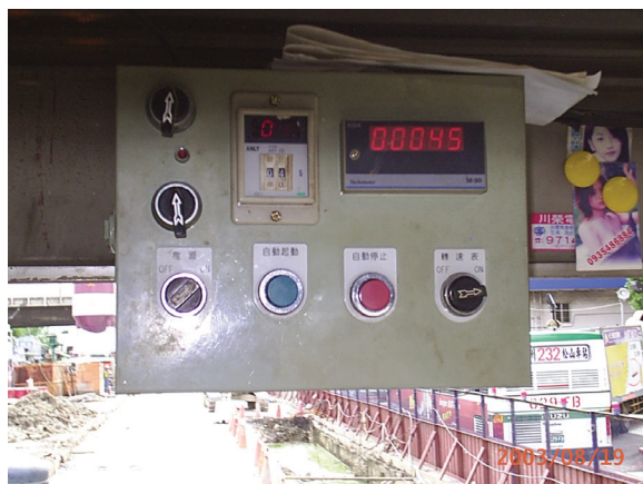
儀器介紹：鑽桿之轉速及提升速度控制器
